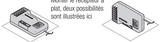
Vous pouvez monter le récepteur depuis n'importe lequel de ses six côtés, le sens du récepteur n'a aucune importance. Le récepteur ne doit pas être aligné avec le véhicule, tant qu'il est plat et nivelé.
