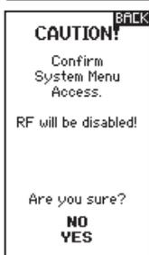
Enfoncée et maintenez la molette tout en allumant l'émetteur pour afficher la liste System Setup (Configuration système). Aucune transmission radio ne se produit quand un écran System Setup (Configuration système) est affiché, afin de prévenir tout dommage accidentel aux liaisons et aux servos lors des changements de programmation.
