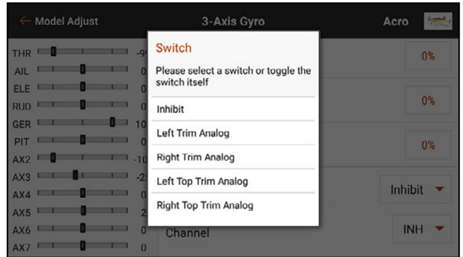
Sélectionnez un Channel (Canal) ouvert pour l'ajustement du gain de gyroscope. Il s'agit du canal auquel le fil de gain du gyroscope doit être connecté. Consultez les instructions fournies avec votre gyroscope pour de plus amples informations sur les connexions.
