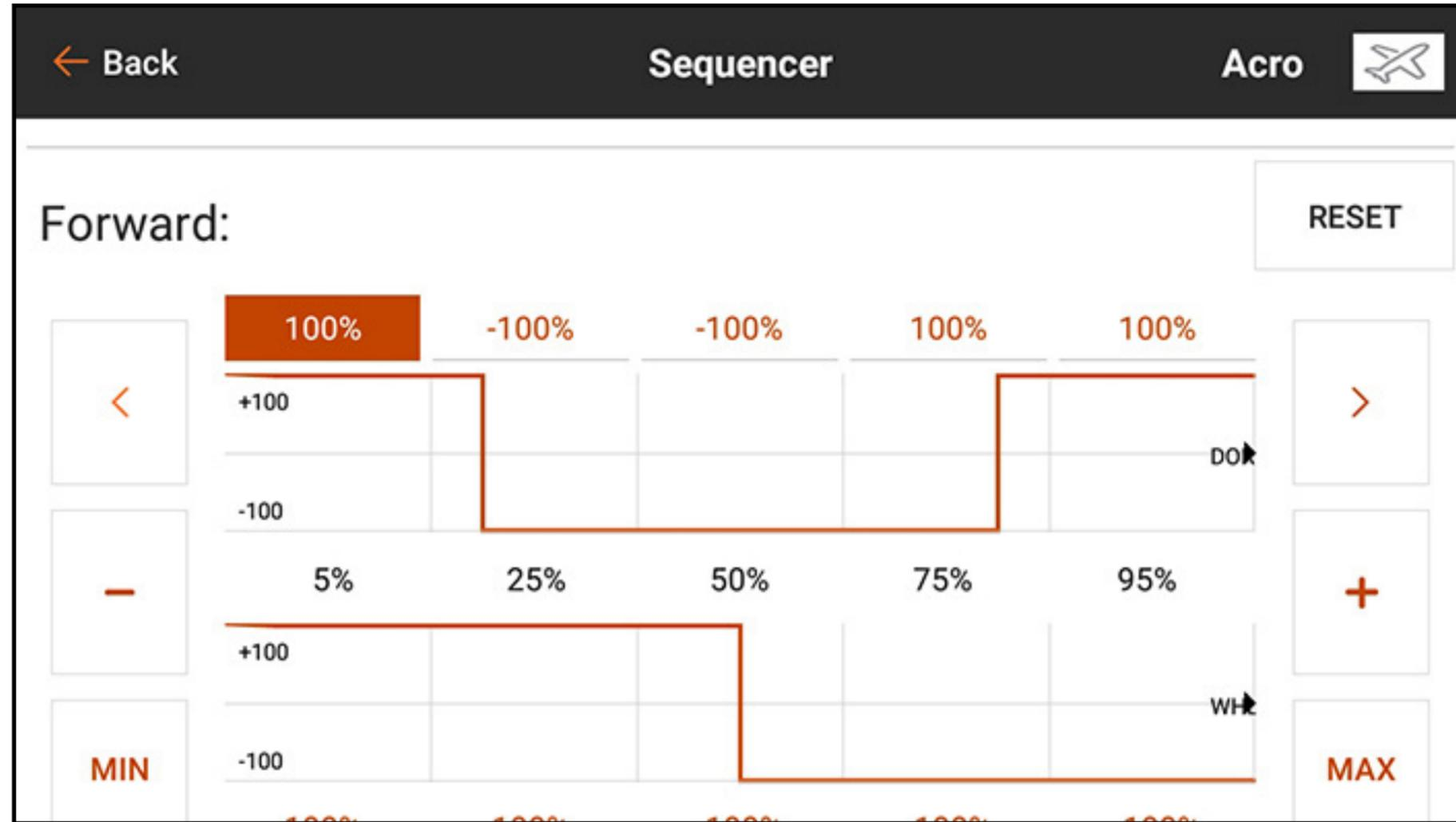
Les séquenceurs peuvent également être configurés pour gérer un mixage. Par exemple, avec des roues de nez rétractables, le mixage de direction peut être désactivé lorsque les roues sont rétractées et activé lorsque les roues sont sorties. Durant la transition lorsque les roues se déploient, la direction de la roue de nez doit être désactivée jusqu'à ce que le train soit entièrement sorti.
