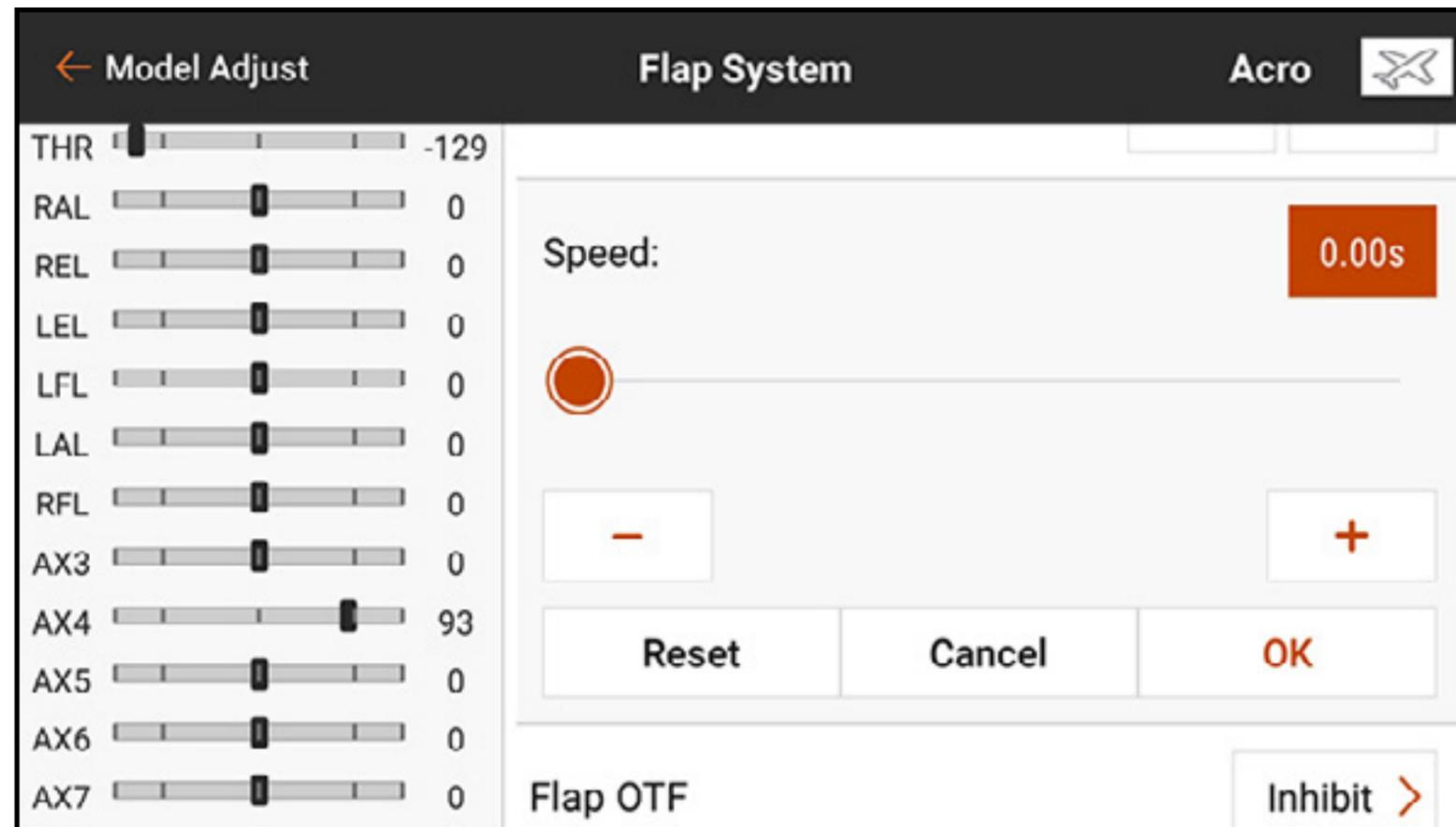
Les paramètres **OTF** permettent d'utiliser les boutons de trim disponibles pour régler avec précision les paramètres de volets en vol. Voir la section **Fonctions de trim On The Fly (OTF)** pour plus d'informations.
