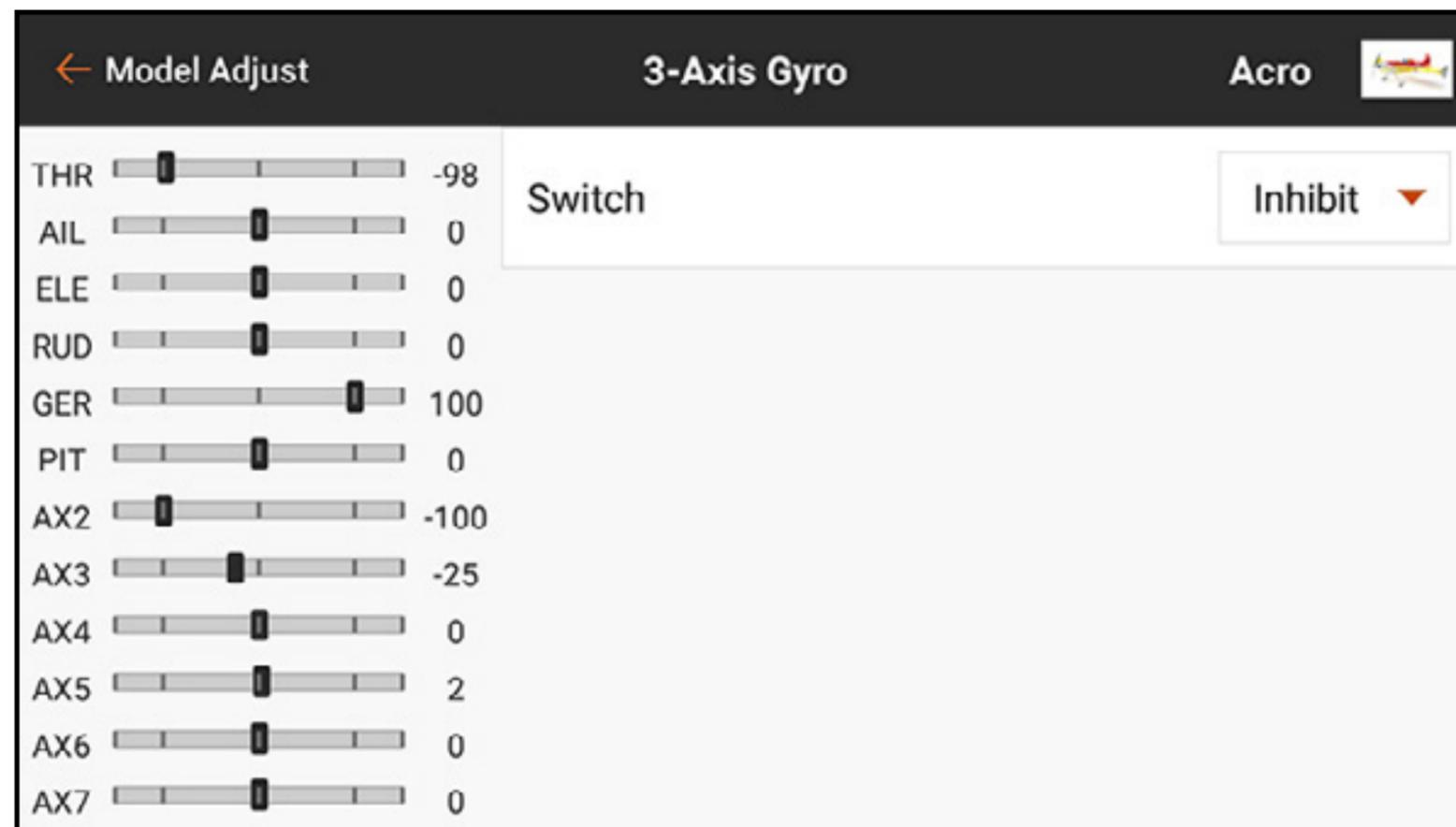
Sélectionnez un commutateur pour activer le gyroscope.
