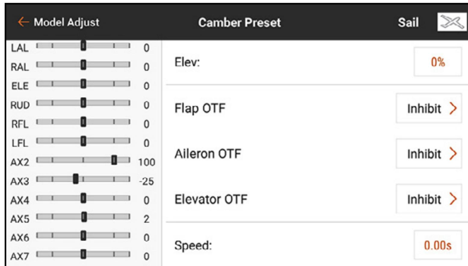
Les paramètres **OTF** permettent d'utiliser l'un des boutons de trim pour régler avec précision les réglages de cambrure de l'appareil en vol. Voir la section **Fonctions de trim On The Fly (OTF)** pour plus d'informations.
