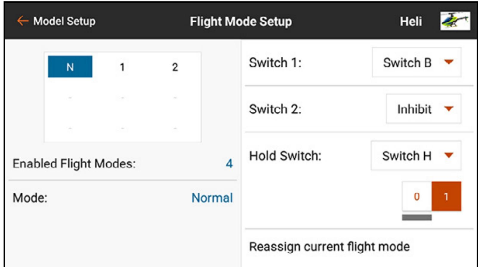
Le maintien des gaz doit être programmé pour zéro gaz pour les hélicoptères électriques, et moteur au ralenti pour les modèles à carburant. Le maintien des gaz a trois utilités pour les pilotes d'hélicoptères :
