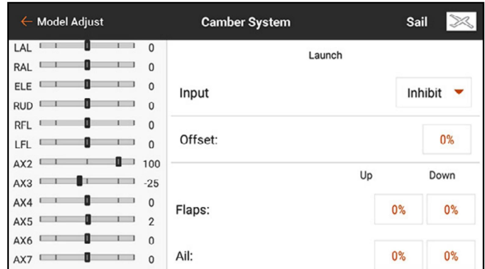
4. Sélectionnez une Input (Entrée) pour le mode de vol sélectionné.
