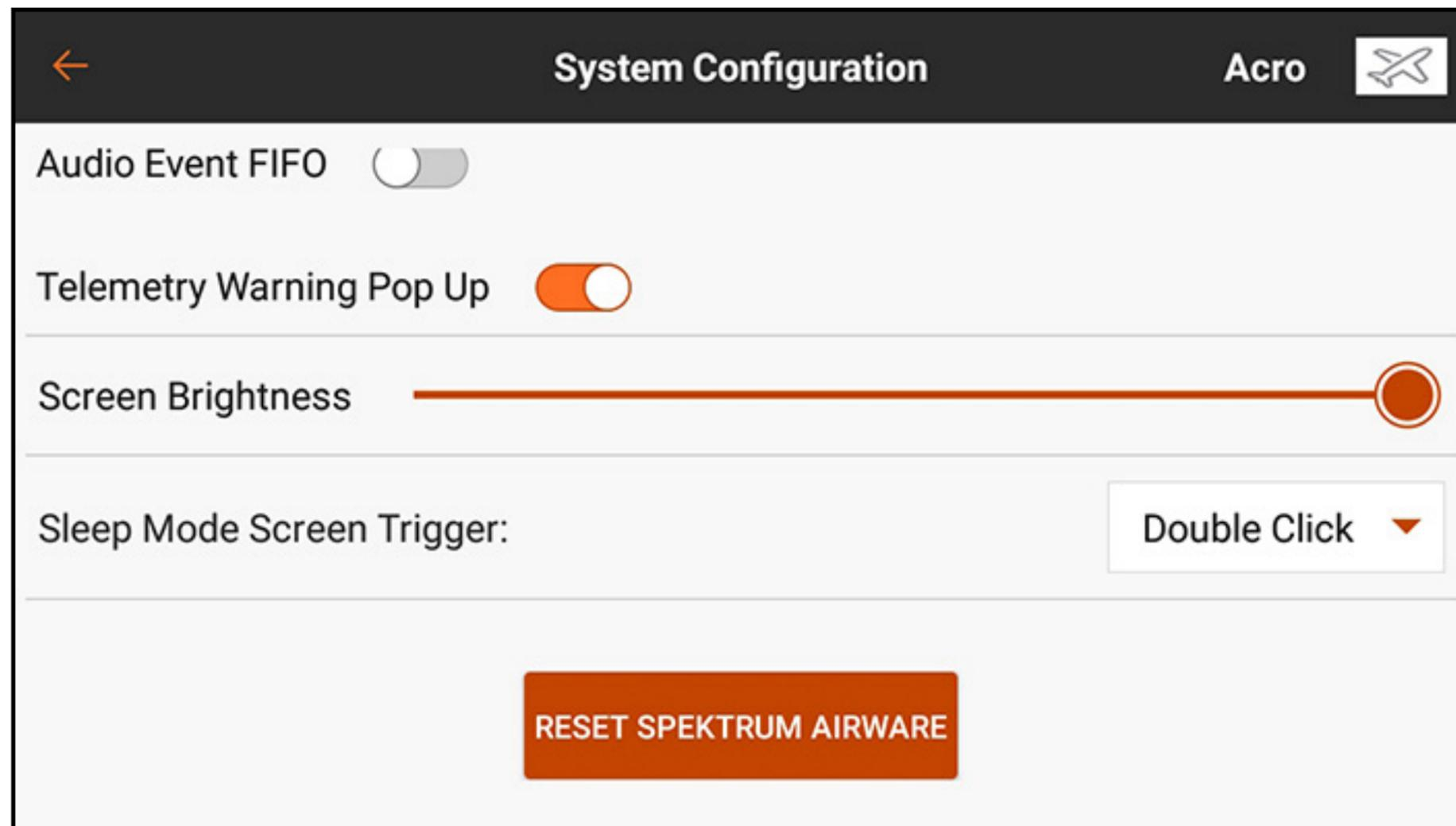
**RESET SPEKTRUM AIRWARE (Réinitialiser le Spektrum Airware)** : Appuyez sur le bouton RESET SPEKTRUM AIRWARE (Réinitialiser le Spektrum Airware) pour effacer tous les modèles stockés et charger un modèle par défaut. Cette action nécessite d'appuyer longtemps pour passer à l'écran d'avertissement suivant suivi d'un redémarrage du système.
