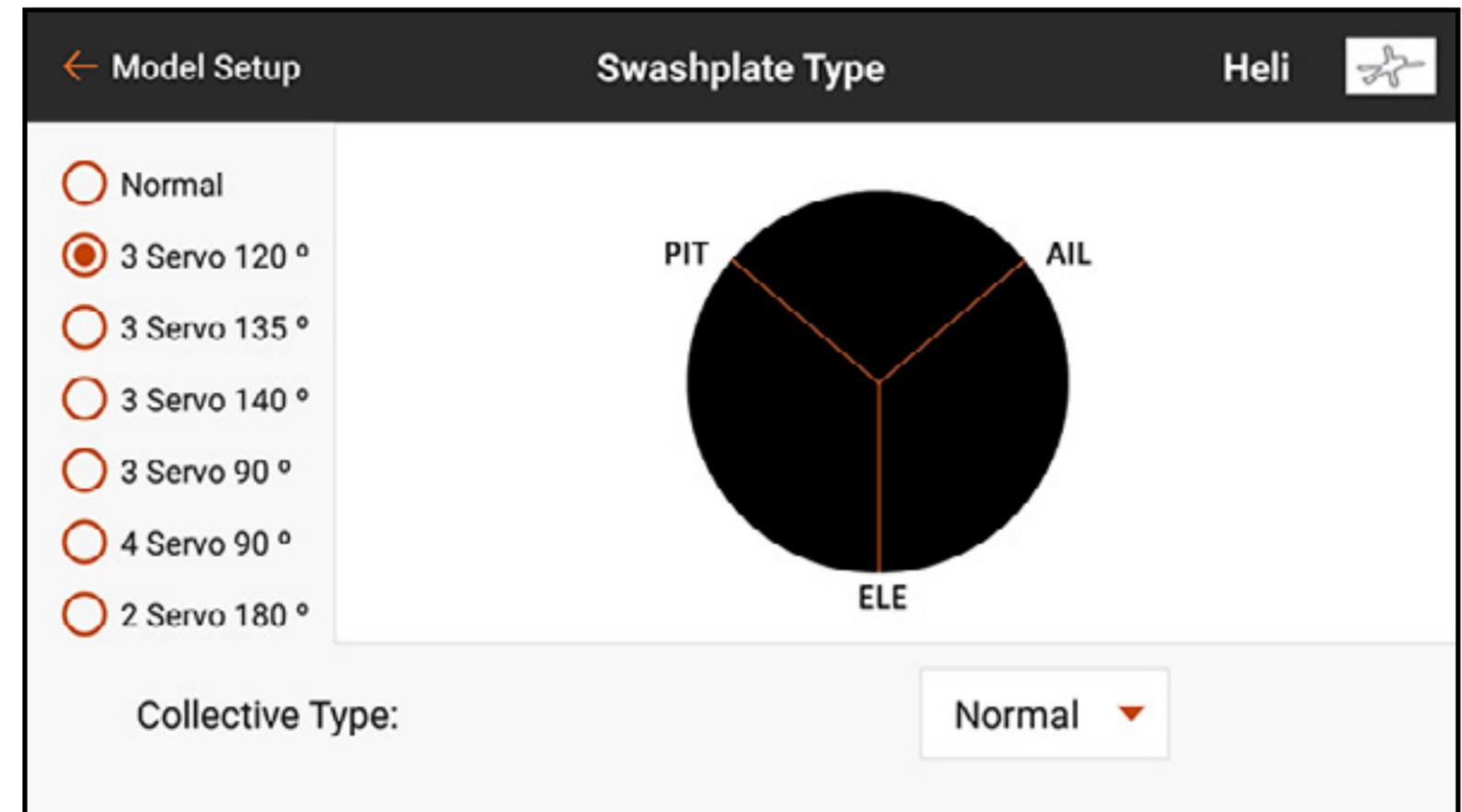
6. Utilisez l'inversion de servo pour vous assurer que le plateau cyclique se déplace correctement pour chaque entrée de commande. À cette étape, le plateau cyclique ne doit pas obligatoirement répondre dans la bonne direction, mais il est essentiel qu'il s'incline correctement avec le tangage et le roulis et se déplace de haut en bas avec le tangage.
