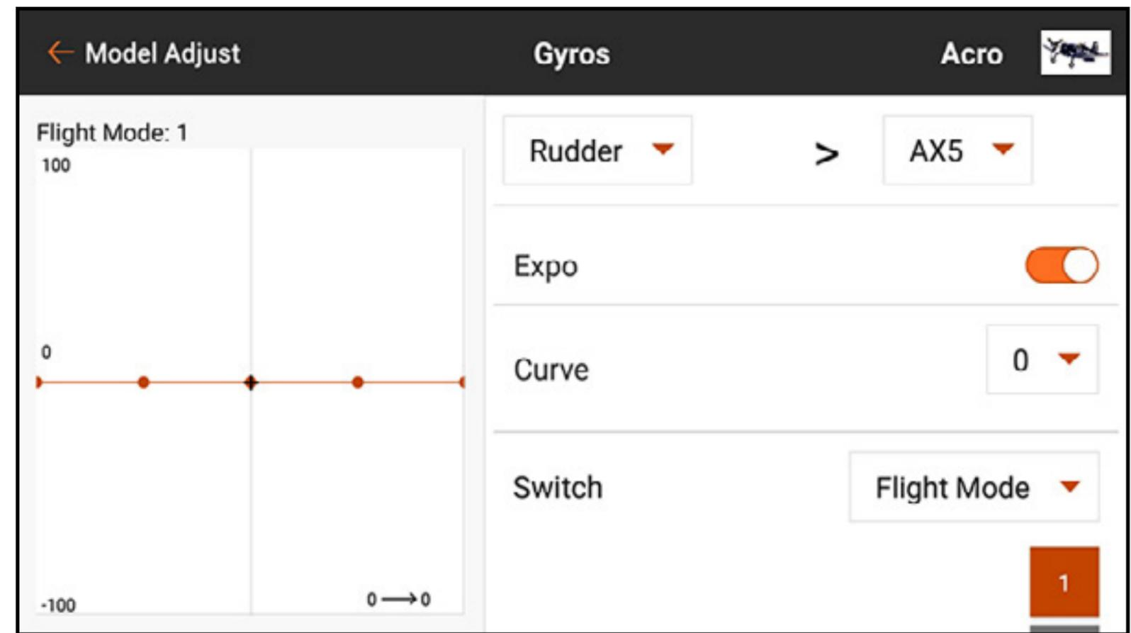
Le type **Aircraft** (Avion) est prévu pour une utilisation avec certains gyroscopes d'avion dotés du mode débattement uniquement qui lisent toute la plage de signal de zéro à 100. Cette sélection modifiera la disposition de la courbe dans le sous-menu **CURVE** (Courbe).
