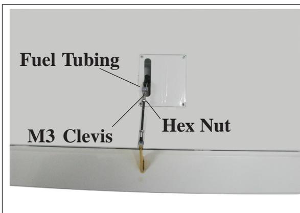
**INSTALLING THE HORIZONTAL STABILIZER.**
