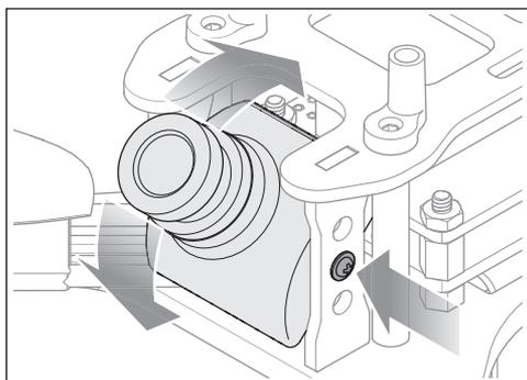
L'angle de la caméra FPV est ajusté en desserrant les deux vis qui maintiennent celle-ci fixée au support et en la faisant pivoter à l'angle désiré. Resserrez les vis pour fixer la caméra. Ne serrez pas excessivement les vis au risque d'endommager la caméra ou le support.
