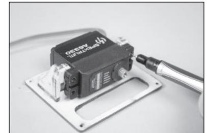
30. Den Servo entfernen und mit einem 1,5 mm (1/16 Zoll) Stiftschraubstock vier Löcher für die Servohalterung bohren.
