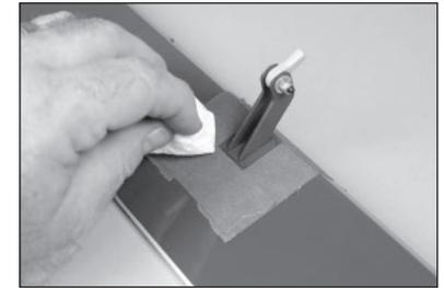
26. Die Querruder mit der gleichen Technik wie für die Aufhängungen der Klappe angegeben einhängen. Sicherstellen, dass das Querruder mit der Rückplatte ausgerichtet ist.
