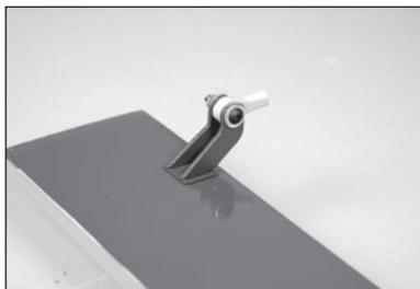
70. Verwenden Sie dieselbe Technik, wie für die Klappenaufhängung zur Sicherung der Aufhängungen des Höhenruders Mit einem Papiertuch und Isopropylalkohol sicherstellen, dass jeglicher überschüssige Klebstoff von den Aufhängungen entfernt wird. Das Höhenruder mit einem Klebeband mit geringer Klebekraft in Position halten, bis der Klebstoff vollständig ausgehärtet ist.
