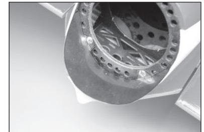
125. Das Auspuffrohr von der Vorderseite des Rumpfs ausgehend hinten am Rumpf einschieben .
