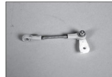
92. Die Kugel auf dem Lenkhebel des Einfahrmoduls einrasten lassen. Das Lenkservo zentrieren und die Länge des Gestänges so einstellen, dass das Bugfahrwerk zentriert ist.
