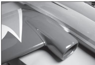
149. Mit einem Feilkloben und einem 1,5 mm (1/16 Zoll) Bohrer die Anbringungsstelle am Einlass in der Tragfläche durchbohren. Den Einlass entfernen und in jedes Loch eine M2 x 8-Blechschaube einschrauben. Die Schrauben entfernen und einen Tropfen dünnen CA-Klebstoff in jedes Loch geben. Nachdem der CA-Klebstoff vollständig ausgehärtet ist, den Einlass mit zwölf M2 x 8-Blechschauben am Flügel sichern.
