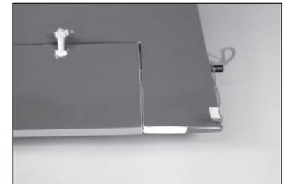
10. Überschüssigen Klebstoff mit einem Papiertuch und Isopropylalkohol entfernen. Mit einem Klebeband mit geringer Klebekraft die Klappe in Position halten, bis der Klebstoff vollständig ausgehärtet ist.
