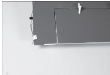
6. Klappe und Aufhängungen entfernen. Jede Aufhängungsaufnahme an der Klappe mit Klebstoff versehen.
