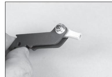
20. Die Steuerhornbasis auf den Boden der Steuerhornbaugruppe schieben.
