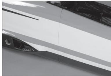
**140.** Den Rumpfbereich mit den fünf zuvor vorbereiteten Schrauben sichern. Die Schrauben mit einem 3mm Sechskant festziehen.
