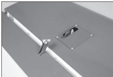
43. Eine Silikonhalterung auf den Metallgabelkopf schieben. Den Gabelkopf auf die Gewindestange von 70 mm schrauben (am mutterseitigen Ende), bis das Ende der Gewindestange zwischen den Zinken des Gabelkopfs sichtbar ist.
