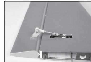
→ Beim Anbringen des Gabelkopfes am Servoarm des Seitenruders das Loch im Arm verwenden, das sich 20 mm (13/16 Zoll) von der Mitte des Servoarms entfernt befindet.
