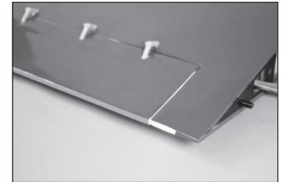
66. Den Verfahrweg auf dem Sender so einstellen, dass eine vollständige Klappenauslenkung von 70 mm (2<sup>3</sup>/<sub>4</sub> Zoll) erreicht wird.
