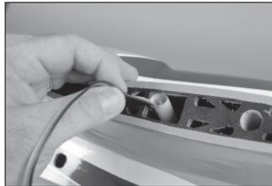
119. Den Anschluss zwischen Stecker und Schnur mit Band umwickeln, um das Ziehen der Verlängerung durch die Manschette zu vereinfachen.
