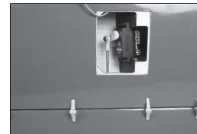
56. Während das Gestänge gehalten wird, die Klappe auslenken. Mit einem Filzstift die Position des Kugelkopfes auf der Unterseite der Tragfläche markieren.
