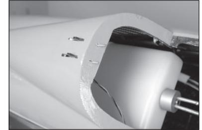
**142.** Die Kanzelabdeckung in Position auf dem Rumpf positionieren.
