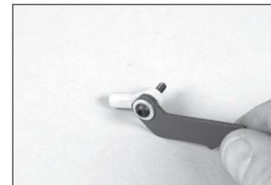
19. Das verbleibende Steuerhorn auf die M3 x 15 Rundkopf-Maschinenschraube schieben. Die Baugruppe mit einer M3 Unterlegscheibe und einer M3 Kontermutter sichern.
