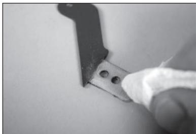
15. Das Querruder-Steuerhorn probeweise einsetzen. Sie müssen vollständig in den Schlitz passen, wie angezeigt. Passen sie nicht, mit einer Feile den Schlitz vergrößern. Keine Kraft aufwenden, um das Horn in Position zu bringen.
