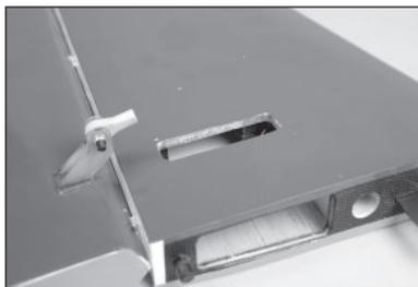
79. Zusammenbauen des Servos des Höhenruders im Stabilisator mit nach außen gerichtetem Servo-Ausgang.
