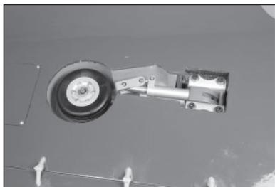
88. Die Funktion des einziehbaren Fahrwerks mit dem Einfahrmodul prüfen. Auf dem Modul befindet sich eine Prüftaste oder das Modul kann mit dem Empfänger verbunden werden, um den Einfahrvorgang zu prüfen.
