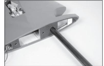
**144.** Das Rohr in die Lasche des Rumpfs schieben. Die Leitungen von Querruder und Klappe an den Verlängerungen anschließen. Die Leitungen von Einfahrvorrichtungen und Bremsen in den Rumpf führen.
