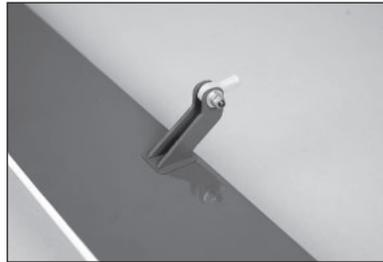
22. Den Bereich um die Steuerbasis mit Klebeband mit geringer Klebekraft abdecken. So wird überschüssiges Epoxid vom Querruder ferngehalten.
