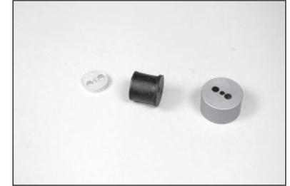
102. Eine langes Rohr und ein kurzes Rohr durch den Gummianschlag schieben. (Die mittlere Öffnung ist für die Schraube zur Sicherung des Zusammenbaus im Tank.) Rückplatte aus Aluminium an den Rohren vom flanschlosen Ende des Anschlags einpassen. Frontplatte aus Aluminium wird auf die Rohre vom geflanschten Ende des Anschlags geschoben.
