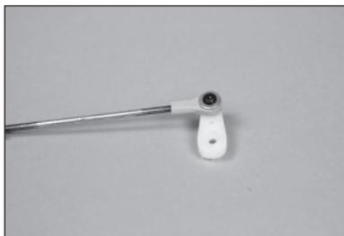
→ Die Unterlegscheiben müssen wie angezeigt installiert werden, um zu verhindern, dass die Kugel aus dem Kugelkopf springt.
