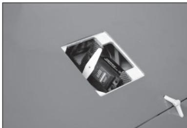
51. Den Kugelkopf mit einer M3 x 15 Maschinenschraube, einer M3-Unterlegscheibe und einer M3-Kontermutter am Servoarm befestigen. Die Hardware mit einem 2mm Sechskant und einem 5,5 mm Steckschlüssel festziehen. Darauf achten, die Hardware nicht zu fest anzuziehen.
