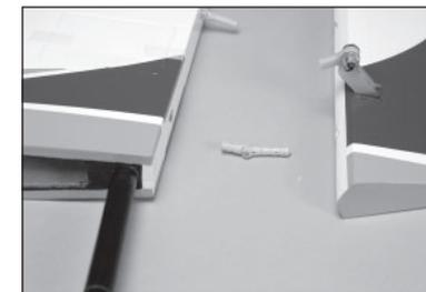
74. Verwenden Sie dieselbe Technik, wie für die Klappenaufhängung zur Sicherung der Aufhängungen des Seitenruders Mit einem Papiertuch und Isopropylalkohol sicherstellen, dass jeglicher überschüssige Klebstoff von den Aufhängungen entfernt wird. Das Seitenruder mit einem Klebeband mit geringer Klebekraft in Position halten, bis der Klebstoff vollständig ausgehärtet ist.
