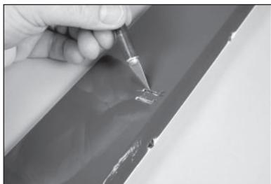
13. Den Bereich der Querruder-Steuerhörner dort leicht schleifen, wo sie ins Querruder eingepasst werden. (Die Querruder-Steuerhörner sind die längsten im Lieferumfang enthaltenen Hörner.)
