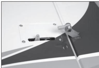
77. Das Ruderservo-Gestänge montieren. Mit einer 35 mm Gewindestange die Verbindung auf eine Gesamtlänge von 65 mm einstellen. Die Länge der Verbindung so wie nötig einstellen, um das Seitenruder bei eingeschaltetem Funksystem zu zentrieren.
