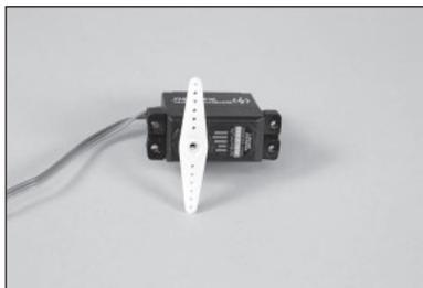
50. Den Klappen-Servo mit nach außen weisendem Ausgang in Position bringen. Mit einem Seitenschneider den überschüssigen Servoarm entfernen, der aus der Servoöffnung herausragt.
