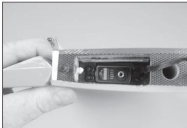
→ Achtung: Darauf achten, dass die Löcher für die Servobefestigung gleichmäßig von dem Schlitz für das Servokabel beabstandet sind.
