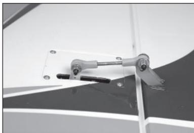
→ Beim Anbringen des Kugelkopfes am Servoarm des Seitenruders das Loch im Arm verwenden, das 20 mm (13/16 Zoll) von der Mitte des Servo-Arms entfernt liegt.
