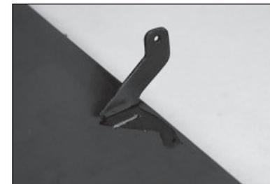
16. Den Aluminium-Gelenkkopf in das Kunststoff-Kugelende einsetzen.
