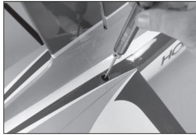
**136.** Zum Einsetzen der Hülse der Stabilisatorschraube eine kleine Menge Silikonklebstoff verwenden.
