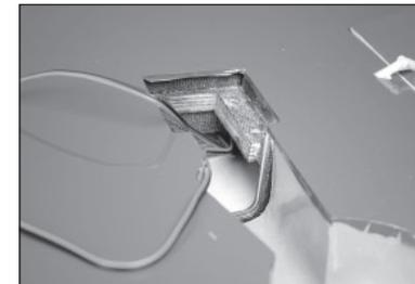
85. Die Leitungen vom selben Ort holen wie die Leitungen für Klappe und Querruder. Sicherstellen, dass die Leitungen beschriftet sind, damit sie bei der Montage des Modells für den Flug identifiziert werden können.
