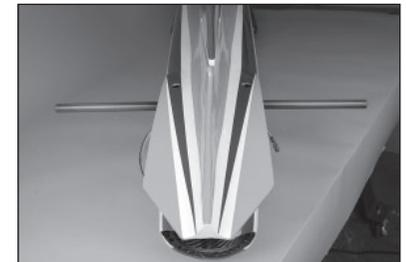
**135.** Die Leitung des Höhenruder-Servos und die Verlängerung mit einem handelsüblichen Befestiger anschließen. Den Stabilisator auf das Rohr schieben. Mit einem 3 mm Sechskant die Schraube anziehen, die den Stabilisator am Rumpf sichert.
