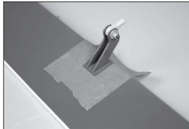
23. Die Baugruppe entfernen und 15 ml (1/2 oz) 30-minütiges Epoxid mischen. Epoxid in die Schlitzte der Steuerhörner geben.
