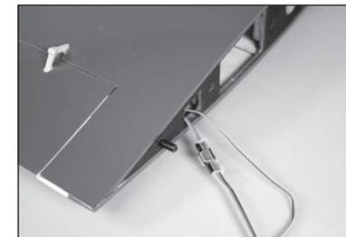
54. Den Servo mit dem Funksystem zentrieren. Den Servoarm am Servo platzieren, mit einer Verzahnung zur Hinterkante des Flügels.
