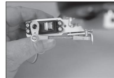
93. Die Einfahrvorrichtung im Vorderteil des Rumpfs einpassen. Sicherstellen, dass alle Leitungen sich innerhalb des Rumpfs befinden und nicht zwischen Rahmen des einziehbaren Fahrwerks und Rumpf.
