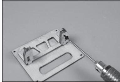
32. Ein bis zwei Tropfen dünnen CA-Klebstoff in jedes Loch auftragen, um das umgebende Holz zu härten. Der CA-Klebstoff muss vor dem Fortfahren vollständig ausgehärtet sein.
