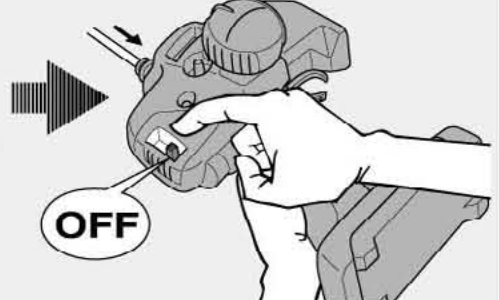
⑤ 走行を終わらせる時は、かならず走らせる時の逆の手順でスイッチを切っていきます。
