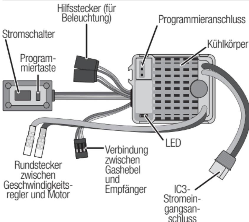
**HINWEIS:** Nach jeder Nutzung des Fahrzeugs den Akku vom Geschwindigkeitsregler abklemmen. Bleibt der Akku mit dem Stromschalter in der OFF-Position verbunden, so zieht der Geschwindigkeitsregler bei einem Anschluss am Akku weiterhin Strom, was möglicherweise zur Beschädigung des Akkus durch eine übermäßige Entladung führen kann.
