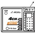
Cuando el LED se enciende el receptor se vuelve sólido, el proceso de unión se completa.
