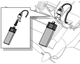
Setzen Sie für die beste Flugleistung den Akku ganz hinten ein.
